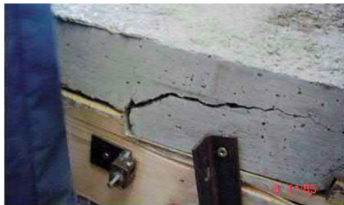
Abb. 5: Konsolveragen Beton, aus [7]
